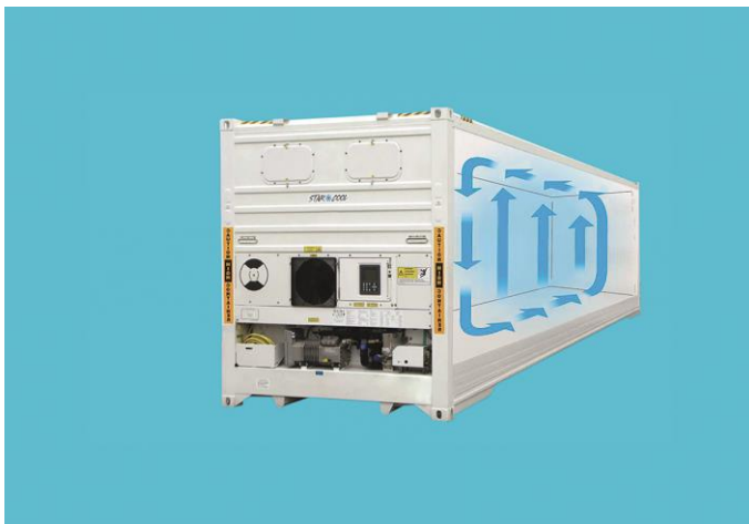
Abb. 2 Schematische Darstellung Luftzirkulation im geschlossenen Container.
