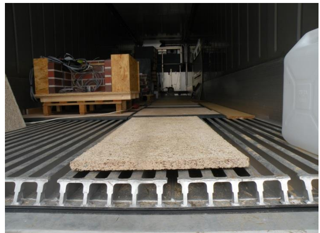
Abb. 3 Grätings am Containerboden. Versuchsaufbau im Testcontainer am IBP.
